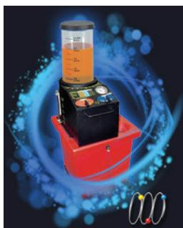
Cette station de vidange de liquide de refroidissement permet le remplacement du liquide de refroidissement en quelques minutes avec une facilité exemplaire. Une fonction test d'étanchéité du circuit de refroidissement est également intégrée. Elle se connecte très rapidement à la place du bouchon de vase d'expansion grâce aux adaptateurs fournis. Capacité du réservoir de liquide propre 11L, capacité du bac de collecte de liquide usagé 45L.
